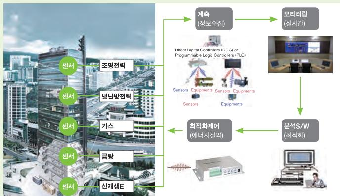
\* 건물 내 에너지 사용기기(조명, 냉·난방설비, 환기설비, 콘센트 등)에 센서 및 계측장비를 설치하고 통신망으로 연계하여, 에너지원별(전력·가스·연료 등) 사용량을 실시간으로 모니터링하고, 수집된 에너지사용 정보를 최적화 분석 S/W를 통해 가장 효율적인 관리방안으로 자동제어하는 시스템
