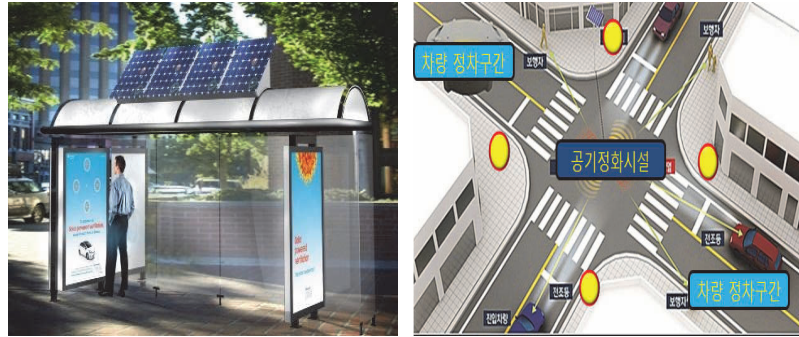
[그림 3-24] 물리적 미세먼지 저감장치를 활용한 도시 내 미세먼지 대응 출처: 경대승(2019, p.96.)
