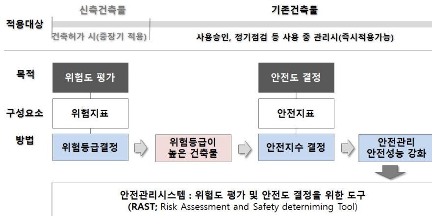
[그림 3-1] 안전관리시스템(RAST)의 개념도
