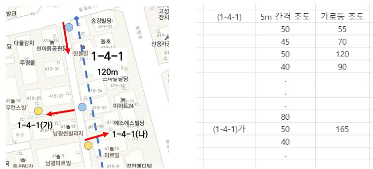
[그림 4-4] 6m 미만 가로에서의 조도 측정 및 기록 방법
