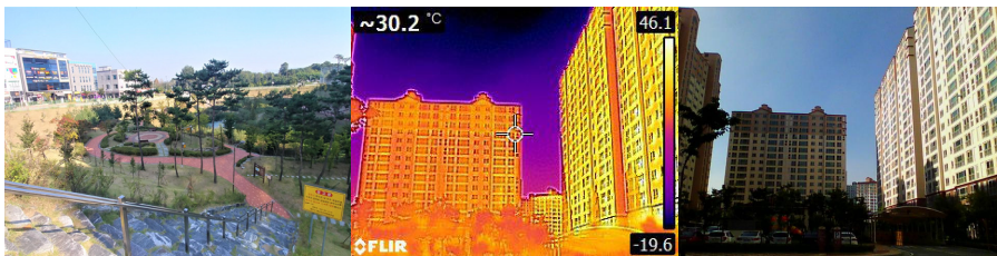
[그림 3-20] 청주시 오창읍 일대 유수지공원(좌)과 주동 향에 따른 표면 온도의 차이 비교 (중, 우) - 건축물 표면온도 : 최대 46.1°C, 건물 그늘 30.2°C, 최저 19.6°C
