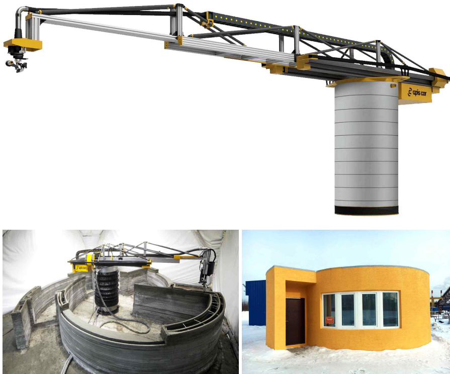
[그림 3-53] Apis Cor가 개발한 이동가능한 건설용 프린터 및 프로토타입
