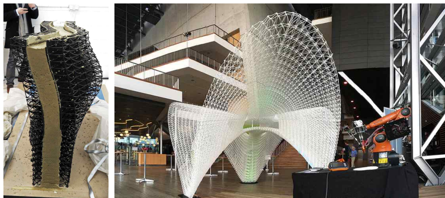
[그림 3-55] Ai Build의 벽채용 거푸집(좌)과 Arup과 작업한 파빌리온(우) (출처: https://ai-build.com/projects.html )
