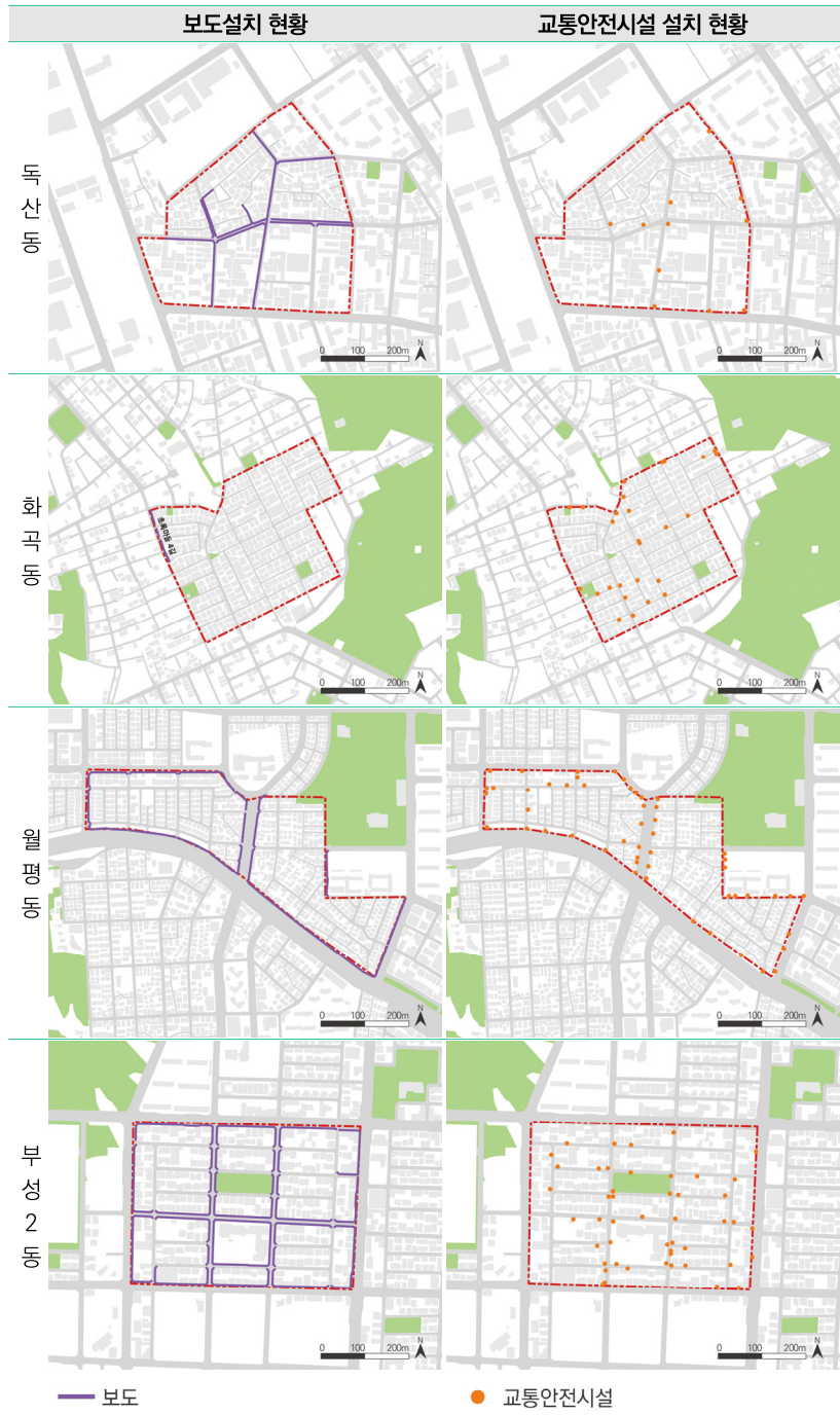
[그림 5-37] 심층조사 대상지의 보도설치 현황(좌) 및 교통안전시설 설치 현황(우)
