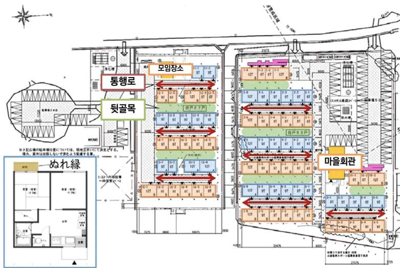
[그림 3-16] 구라시키시 건설 가설 주택 단지 설계도
