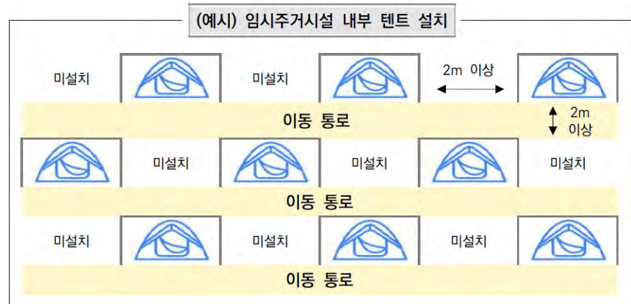
[그림 2-15] 임시주거시설 내부 텐트 설치 예시
