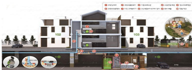
[그림 3-22] 세대형 음식물 제로화 스마트리사이클링 시스템 개념도
