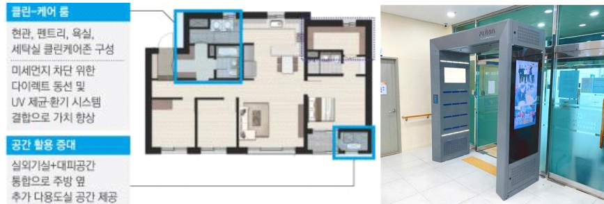
[그림 2-15] (좌) 현관 출입구 살균공간 설계 / (우) 스마트 IoT 에어샤워
