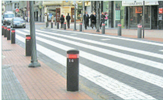
[그림 4-49] 야간안전을 위한 볼라드 조명 출처: 박준휘 외(2014)
