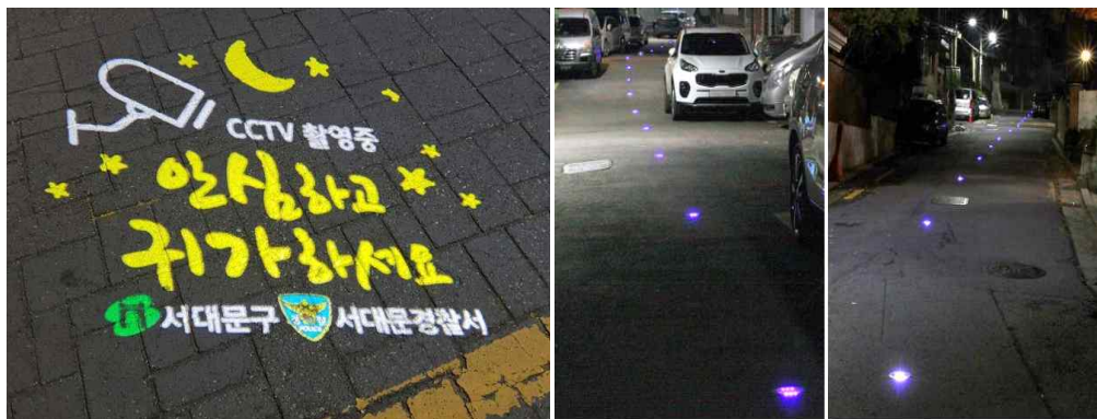
[그림 5-55] (좌)여성안심귀갓길 로고젝터 사례, (우)여성안심귀갓길 태양광 표지병 사례 출처: 서대문구청 공식블로그( https://tongblog.sdm.go.kr/4429 , 검색일자: 2020.11.18.)
