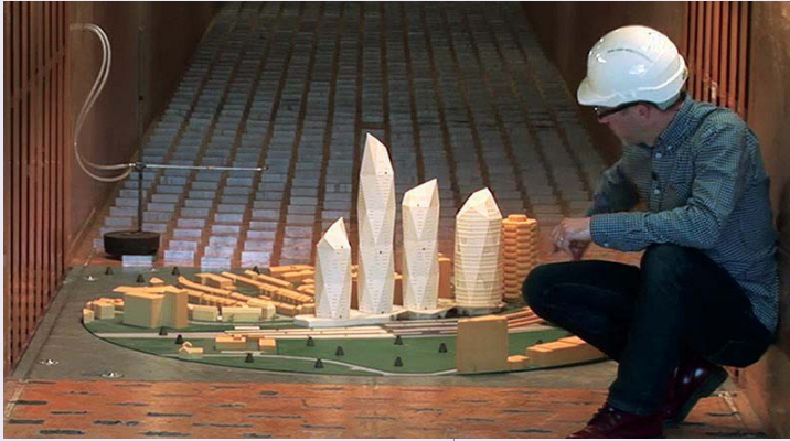
BRE의 풍동실험실(Wind Load Testing Lab)
