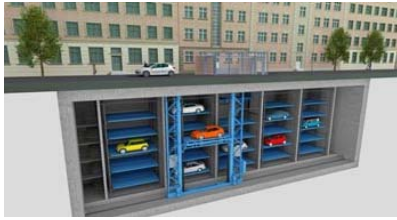
[그림 36] 자동화 지하 주차 시설 구조
