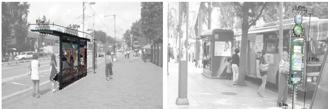
[부록 그림1.9] 상업지역 보행로내 셸터형 버스정류장(좌) 및 폴대형 버스정류장(우)의 치수 비교
