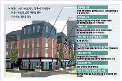
붉은벽돌 건축물 디자인 가이드라인(서울특별시 성동구)
