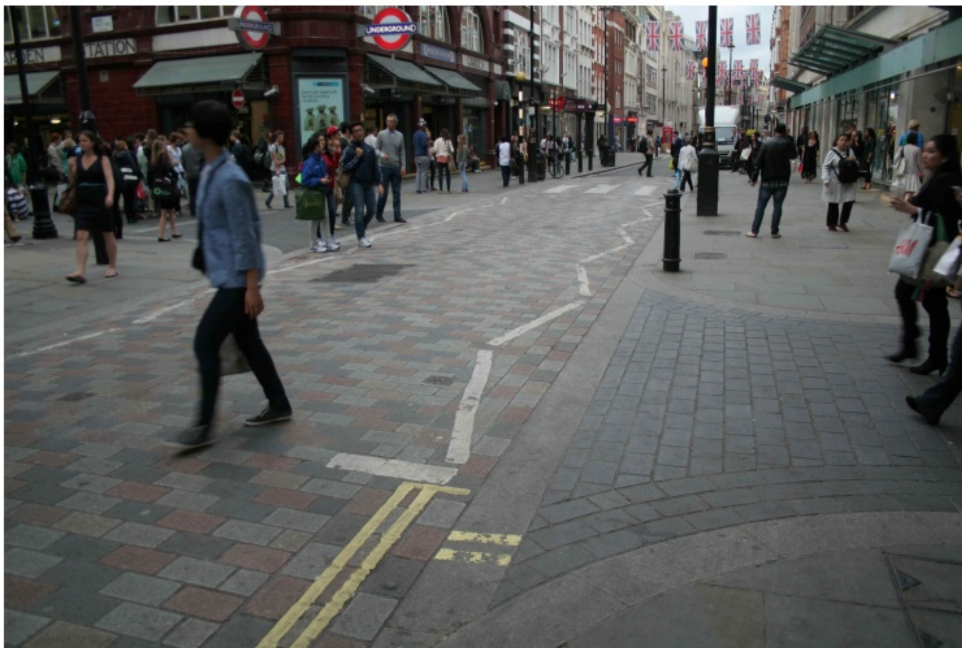
Covent Garden 지하철역 앞, 전체적으로 도로 표면을 들어올리고 표면 재질을 변화시켜 통과차량의 서행을 유도하고 보행자들이 자유롭게通行할 수 있게 하였다.
