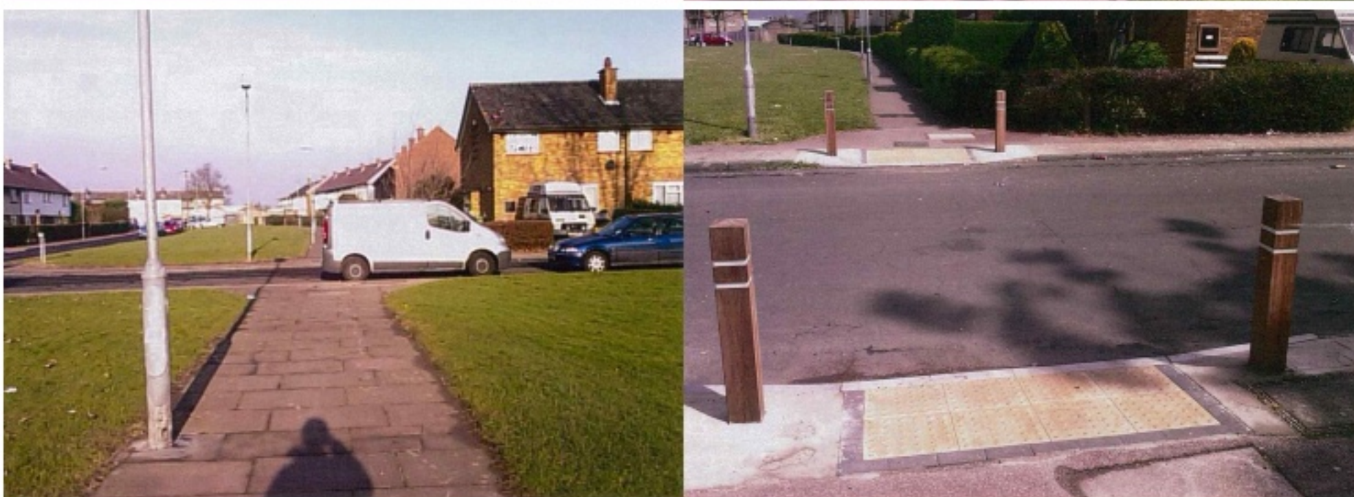
항상 주차된 밴에 가로막힌 건널목에 횡단보도와 턱낮춤을 설치하여, 주차위치를 옮기도록 유도하였다. 이 덕분에 보행경로를 따라 연속적 시야가 확보되었다.
