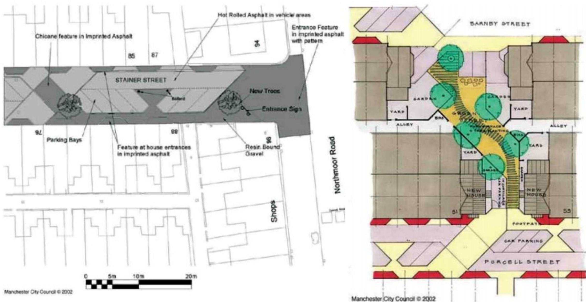
Stainer Street의 진입부와 주차모듈을 표시한 설계도면(좌)과 도로 중간지점을 연결하는 Green Street(우) 출처: Webster et al(2006), Pilot Home Zone Schemes: Summary of the Schemes, TRL Report 654, p.30.
