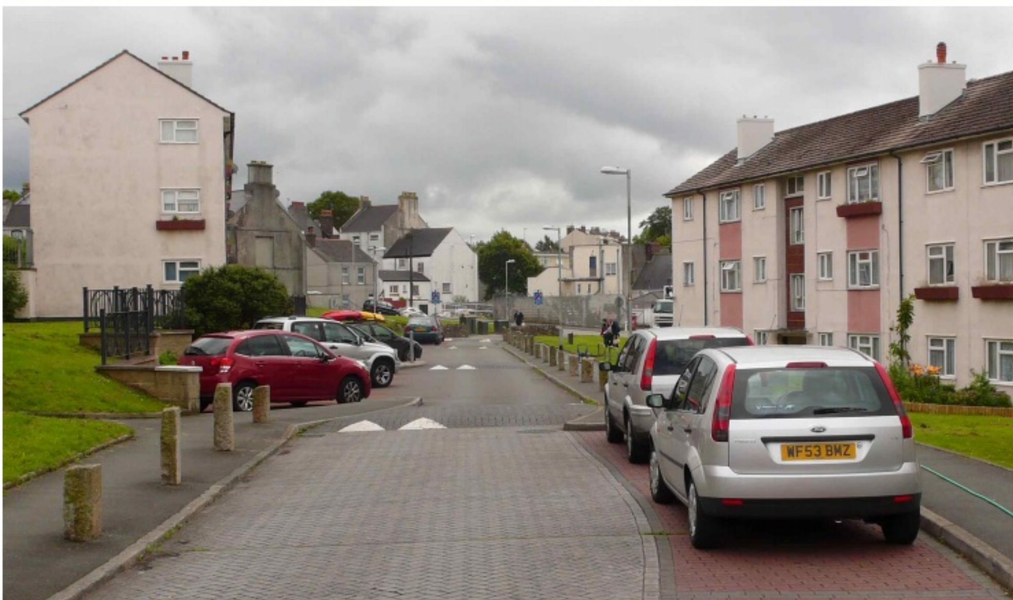
과속방지턱의 역할을 겸하는 고원식 횡단보도가 연속적으로 설치된 모습.
