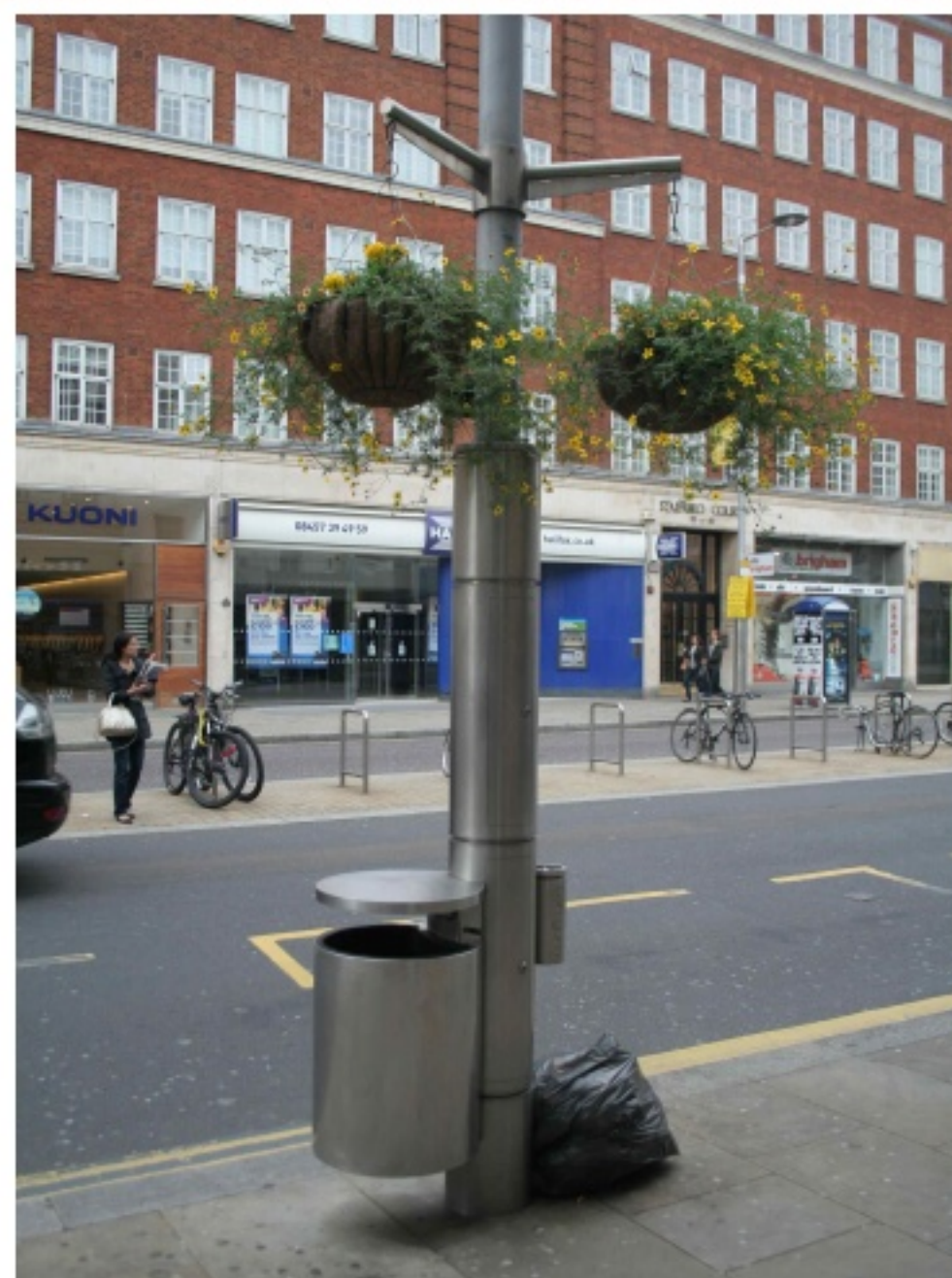
정비된 보도의 모습. 차도용과 보행용이 통합된 가로등은 안내표지판이나 현수막, 화분, 휴지통 등을 매달 수 있도록 설계되었다.
