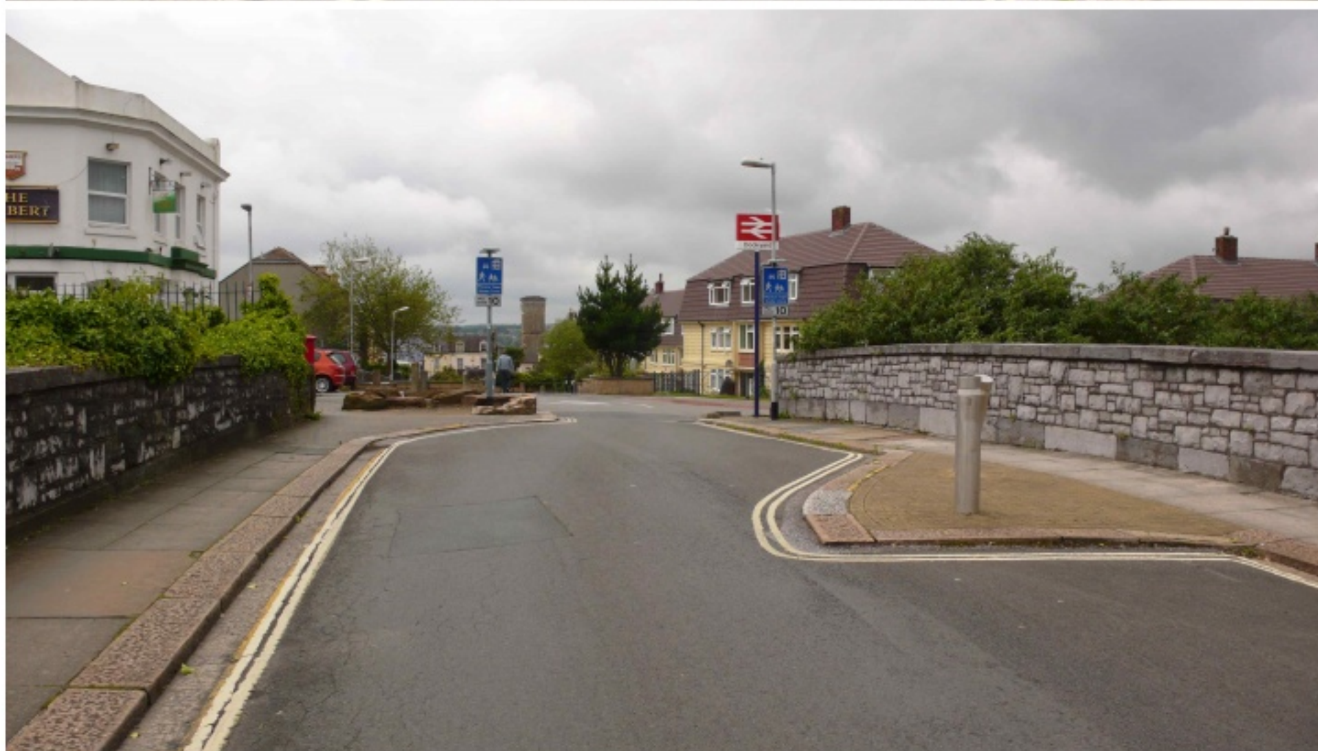
대상지에 접근하는 차량의 진입속도를 크게 줄이기 위해, 진입부 바로 앞 구간의 도로양쪽에 돌출된 포트를 설치하였다.
